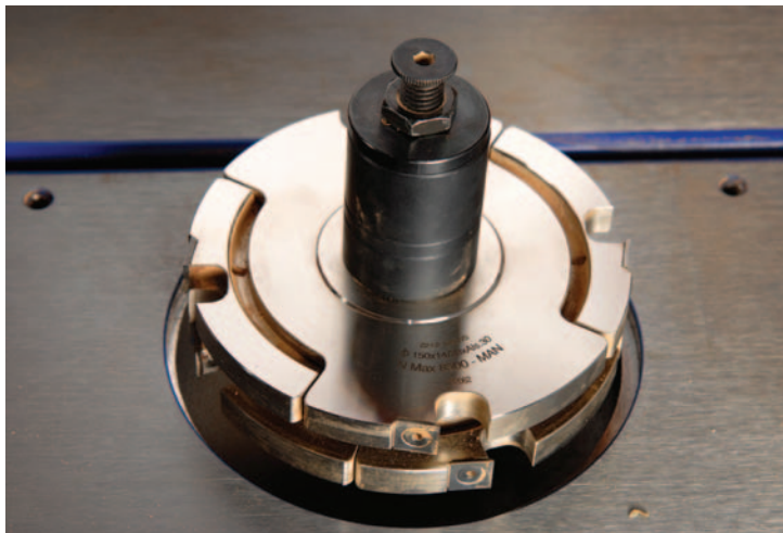
Tenonneuse équipée de deux plateaux à tenonner. L'utilisation de deux plateaux permet de réaliser des tenons précis en une seule passe.
