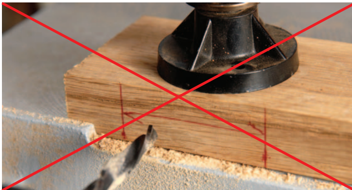
Mortaise incorrecte : l'assemblage sera trop lâche.
