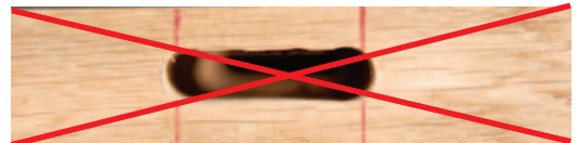
Mortaise incorrecte : l'assemblage sera trop lâche.
