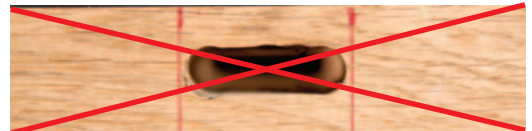
Mortaise incorrecte : l'assemblage sera impossible.
