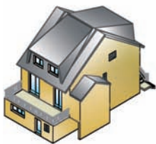
ÉTAT INITIAL Toiture à lucarnes rampantes
