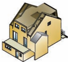
DÉCOUVERTURE ET REPRISE DES EXISTANTS Nivellement des assises maçonnées et protection
