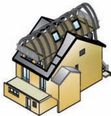
CONTREVENTEMENTS ET RECOUVERTURE Panneaux de sol, garde-corps et réemploi des tuiles
