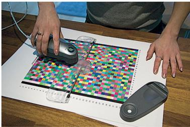
**Figure 12.10** Une fois la mire imprimée, les rectangles de couleur sont mesurés à l'aide d'un spectrophotomètre. Les valeurs obtenues sont utilisées par un logiciel tel que ProfileMaker Pro pour créer un profil ICC.
